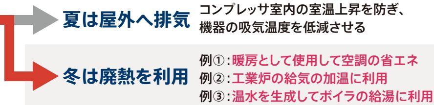
50°C～の廃熱(排気)を活用。切り替えダンパを活用して、夏場は廃熱をコンプレッサ室の屋外へ排気・冬場は廃熱を暖房(温風)や工業炉の加温、温水の生成などに活用。
