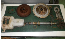
ポンプの分解整備部品交換
